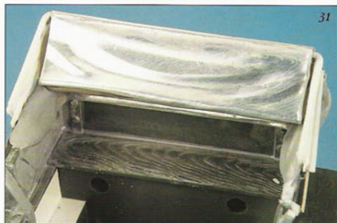
31. Cuando aún esté blanda la masilla, se le imparte la última capa de estaño, habiendo efectuado previamente las arrugas.
