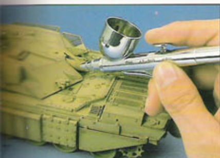
7. Antes de comenzar los camuflajes, hay que dar el color base, que se consigue con pasadas sucesivas de izquierda a derecha y viceversa, con el color no muy espeso.
