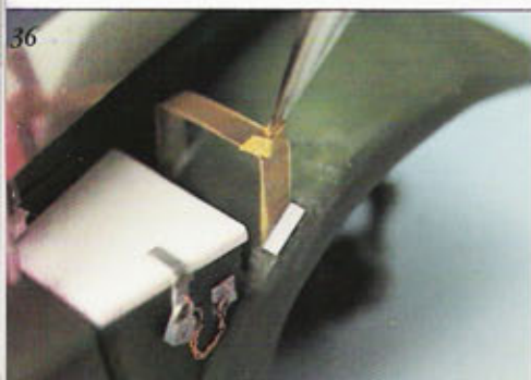
30. Las partes de diferentes materiales se unifican con una nueva porción de masilla.
