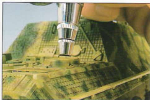
30. Para su realización se necesita un aerógrafo bastante preciso. Es necesario acercarse bastante al carro, pero ¡ojo!, que sea excesivo el flujo de aire, pues se nos producirán patas de araña.
