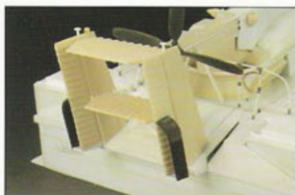
61-62. Ubicación del conjunto del timón de dirección complementado con los refuerzos interiores.
