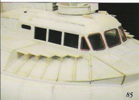
85. El acristalamiento se ha realizado con acetato. En los cristales delanteros se añade un cerco fabricado con alambre.
