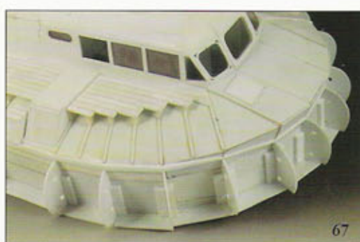
63. Para confeccionar el colchón se parte de una serie de cuadernas con sus distintas formas.
