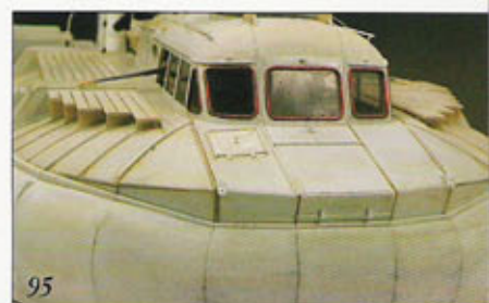
93. Pequeñas piezas complementarias distribuidas por el casco confeccionado con lámina de plástico.
